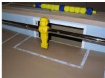
Im nächsten Schritt (oder auch viel später; die Reihenfolge ist jetzt ziemlich beliebig) werden die Toröffnungen gesägt. Die Torrahmen habe ich bei no 2 aus einer einfachen weißen PVC-Winkelleiste selbst gesägt. Die Materialstärke ist bei der Bemessung der Öffnung natürlich als Zugabe zu der Soccer-Torbreite von 20,5 cm zu berücksichtigen. Die Gestaltung des Torinnenraums wird auf der Seite "[Ballrücklauf](#)" näher beschrieben.
