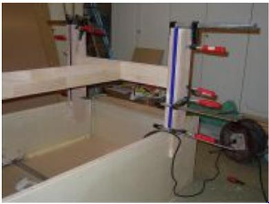
Im sehr kleinfaserigen MDF sind geschraubte Verbindungen nicht sehr stark belastbar, da die Schrauben leicht ausreißen. MDF wird daher besser mit Holzleim verleimt. Holzleim muss allerdings unter Druck abbinden, um seine volle Festigkeit zu erreichen. Hier können wir mit Schraubzwingen arbeiten. Ich habe
