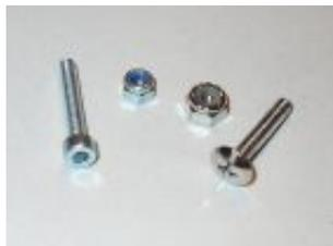
Zur Befestigung an der Stange dienen bei der Ullrich-Figur in China produzierte Schrauben. Gegen die Qualität ist nichts einzuwenden, aber ein Ersatz durch hierzulande produziertes Material ist nicht einfach: die Muttern haben größere Durchmesser als deutsche M 4-Muttern, die Schrauben andere (amerikanische) Gewindesteigungen. Das nebenstehende Bild zeigt die Unterschiede.
