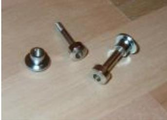
Ergänzung: Das Bild rechts zeigt die neue Leonhart-Verschraubung, bestehend aus der bisher schon verwendeten Hülsenmutter und der neuen Inbus-Schraube mit höherer Zugfestigkeit.
